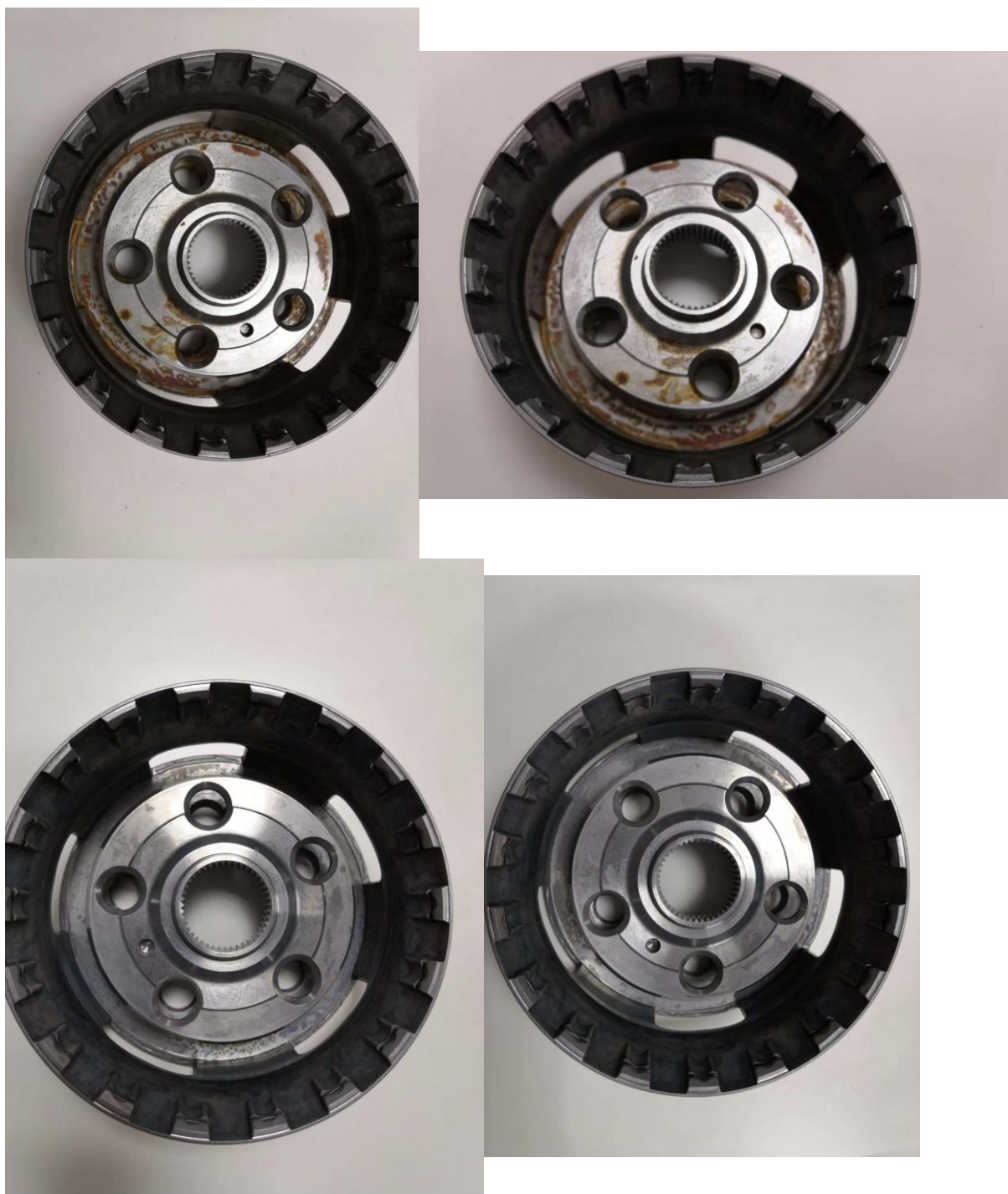
机械齿轮的除锈对比图：
